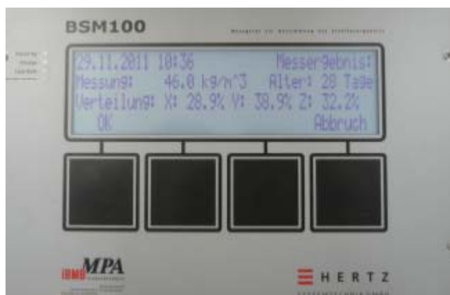
Obr. 10 – Zobrazení hodnot zjištěných přístrojem BSM 100
