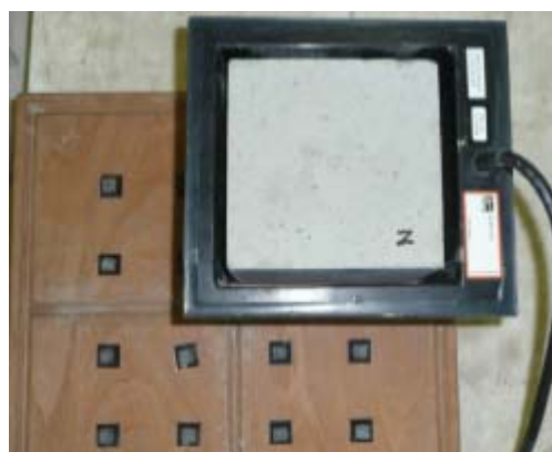
Obr. 8 – Měřicí objímka přístroje BSM 100 Obr. 9 – Měření tělesa ve směru osy “z”
