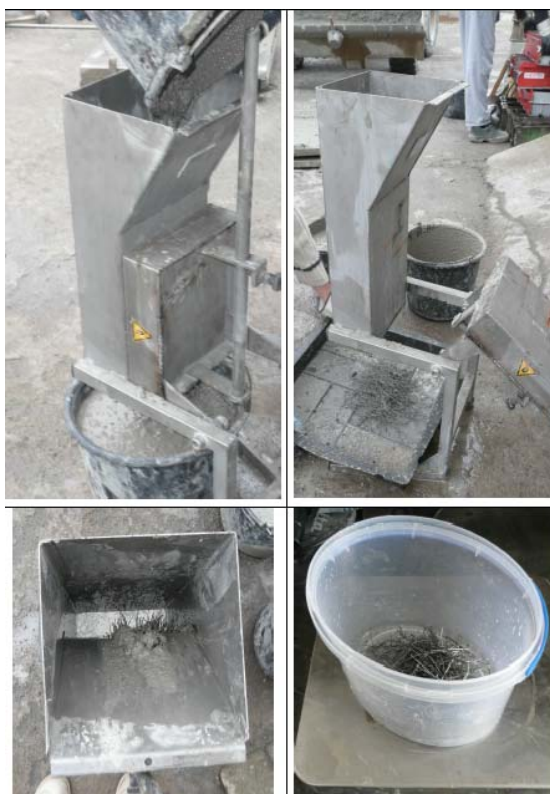
Obr. 6- Ilustrační foto separace drátků - PROFOMETR
