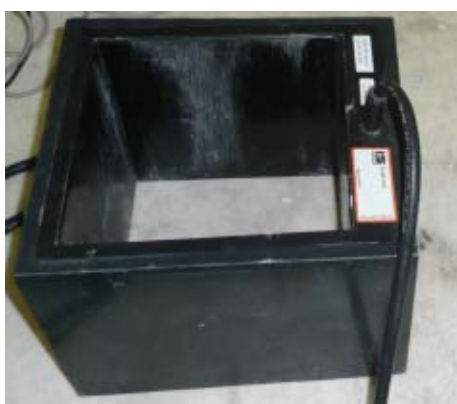
Obr. 8 – Měřicí objímka přístroje BSM 100 Obr. 9 – Měření tělesa ve směru osy “z”
