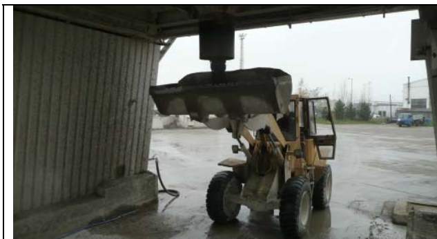
Obr. 3 – Odběr čerstvého drátkobetonu z mísícího jádra
